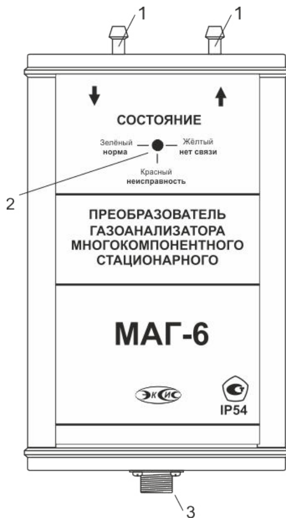
Рисунок 3.18 Измерительный преобразователь с побудителем расхода
